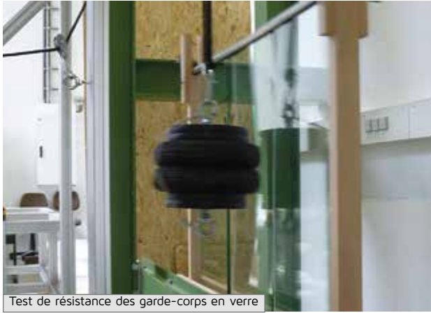
Test de résistance des garde-corps en verre
