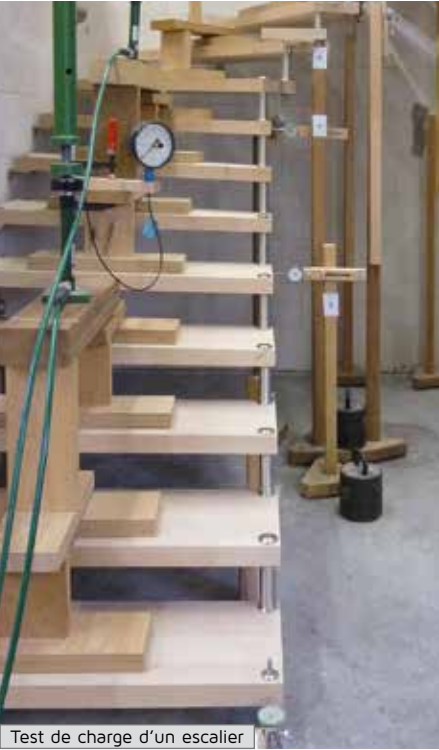
Test de charge d’un escalier
