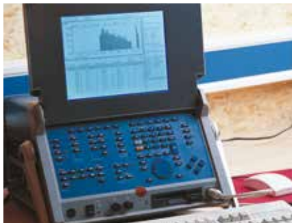
Test sonore de bruit de pas avec système de microphone
